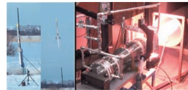
（左）小型ハイブリッドロケットの打上げの様子 （右）推力1.5kNハイブリッドロケットの燃焼実験
