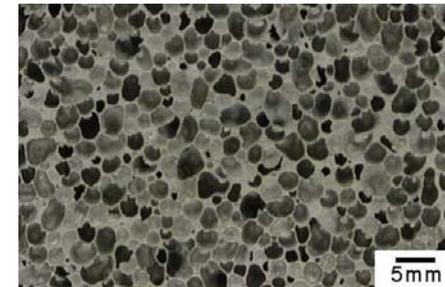
図1 ポーラスアルミニウム(ALPORAS)の断面写真。
